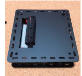
③追加ユニット付属の仕切アクリル板をセットします。ネジ山に合わせてアクリル板をセットしたら、付属する5mmオスメススペーサーのメスネジ部で取り付けてください。
