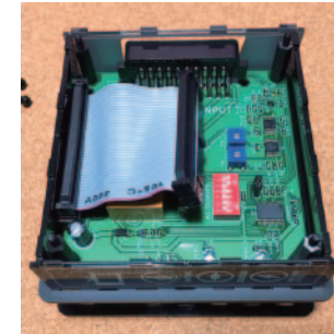
②基板上にある4か所の20mmメスメススペーサーを、追加ユニットに付属している20mmオスメスコネクタへ変更します。次に基板上的コネクタへフラットケーブルを上図のように接続してください。
