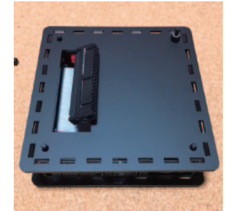
③追加ユニット付属の仕切亚克力板をセットします。ネジ山に合わせて亚克力板をセットしたら、付属する5mmオスメススペーサーのメスネジ部で取り付けてください。
