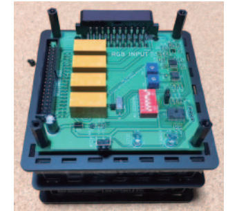
⑥追加ユニットがない(最後尾)場合には、20mmメスメススペーサーで基板を留めます。側面亚克力を取り付けた後、①で取り外した天面亚克力を亚克力ネジで取付してください (→完成図は①と同じです)
