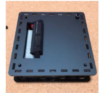
⑥RGB 入力基板などに付属する仕切アクリル板をセットします。入力基板などに付属する 5mm オスメススペーサーのメス部を取り付けてください。
