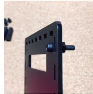
①細長い四角穴の開いている底面アクリル板へ、アクリルネジと 5mm オスメススペーサーを写真のように取り付けます。まず、底面アクリル板のマット面よりアクリルネジを入れてください。そして反対側 (鏡面) へ出たスペーサーのオスネジ部へ、5mm オスメススペーサーのメス部を留めます。4 隅のネジ穴へ 5 ミリスペーサーを固定してください。
